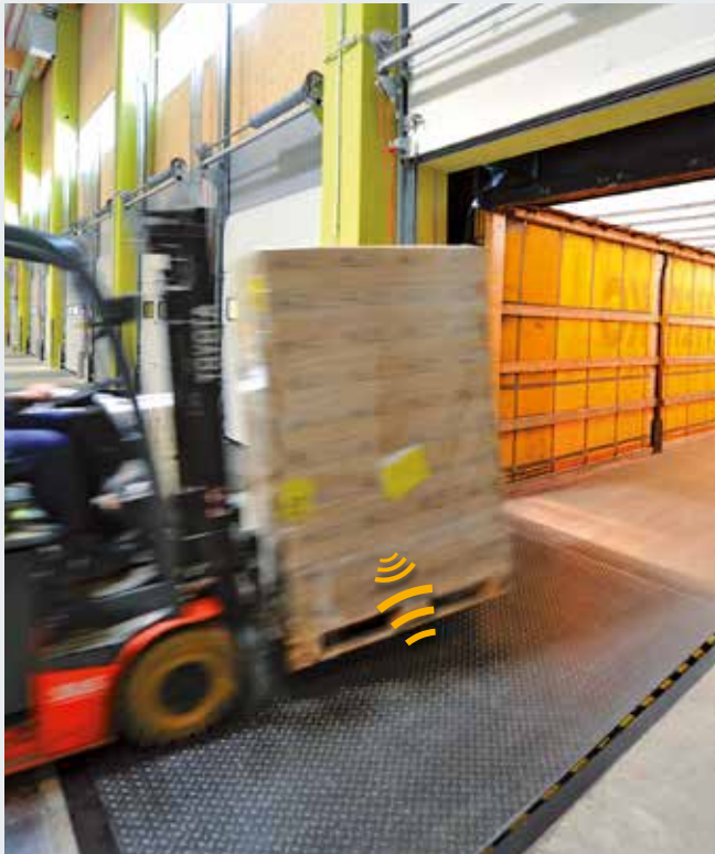
Automatisch registreren van productbewegingen, gewoon bij het rijden over de dockleveller.
